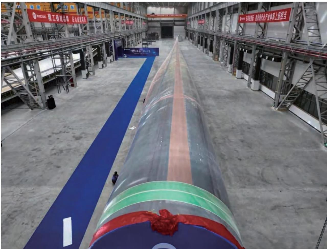
在该款叶片的设计上,明阳延续了风机产品高可靠性的要求,借鉴航空飞行器翼型设计,采用翼型族设计,整体流线型设计使得该款叶片具有更为优异的捕风能力。此外,该叶片还采用了创新式的气弹裁剪技术,让叶片在长度加长、柔性增加的情况下,降低极限载荷,使得叶片边界最高极限风速接近80m/s。
